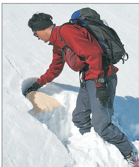
7. Découper de nouveau ~20cm de profond, ou jusqu'à la limite évidente de deux couches.
