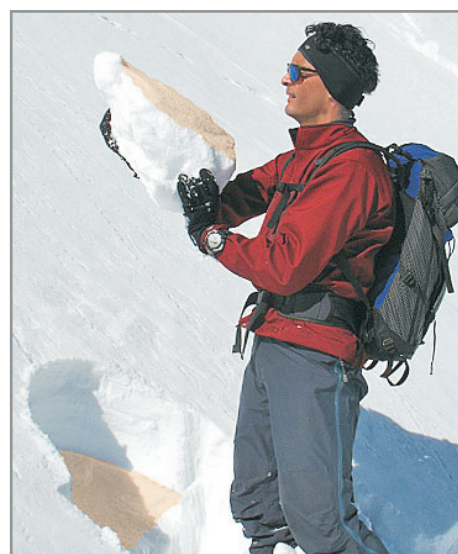
9. Analyser la rupture, les types de grains et la différence de dureté des couches impliquées.
