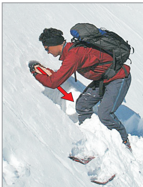
5. Enlacer la boule, la tirer en augmentant la charge parallèlement à la surface jusqu'à la rupture.
