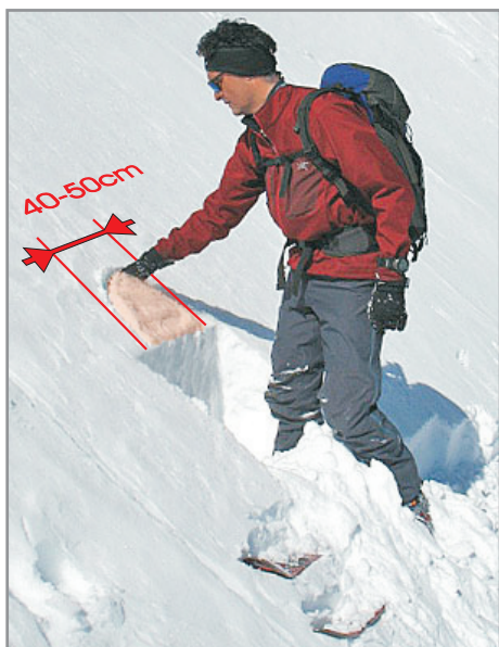
4. Découper un demi-cercle d'une profondeur de main (~20cm), ou jusqu'à la limite évidente de deux couches.
