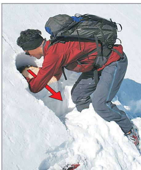
8. Enlacer la boule, la tirer en augmentant la charge jusqu'à la rupture.
