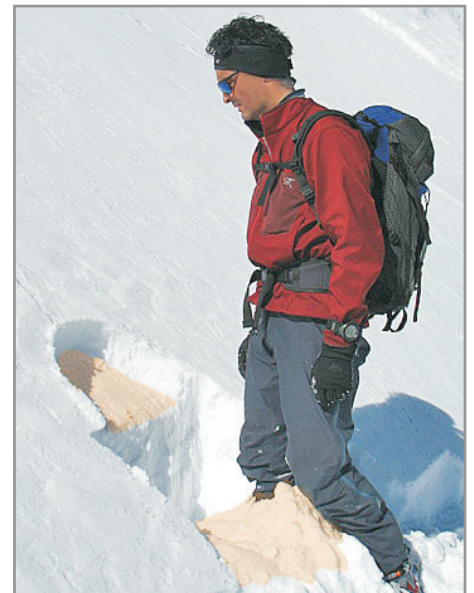
6. Bruchfläche analysieren, oberste Schicht zerbröselte hier in viele kleine Einzelteile
