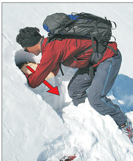
8. Erneut die Belastung schichtparallel bis zum Bruch erhöhen
