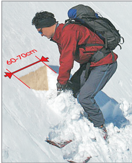
2. Mit den Händen horizontalen Graben freilegen, Breite und Tiefe ungefähr Armlänge
