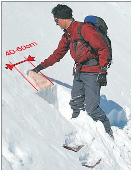
4. Handtief (~20cm) oder bis zu klarer Schichtgrenze halbkreisförmigen Bollen ausfräsen
